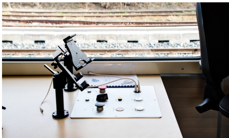
Kontrolní stanoviště dozorujícího strojevedoucího
