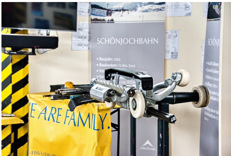
⇨ Svorka uchycující kabinky lanové dráhy k lanu
